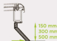
Costière biaisée Polyester isolée ( U = 0,95W/m^2K )
